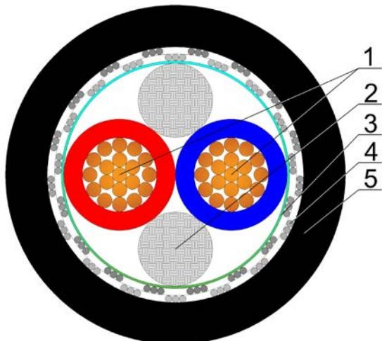
1 - Многожильный медный проводник 2x1,5 кв.мм (2x26x0,25мм.), не ниже 5 класса гибкости по ГОСТ 22483, диэлектрик проводника из термопластичного полимера не поддерживающий горение, безгалогенный (**LSZH**); Изолированные жилы покрыты тальком.
